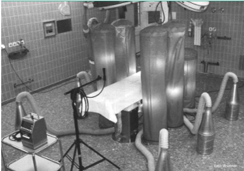
Versuchsaufbau zur Erfassung des Energiebedarfs in Operationsräumen. Die Säulen stehen für das OP-Personal, die gleichzeitig Wärmequellen sind.
